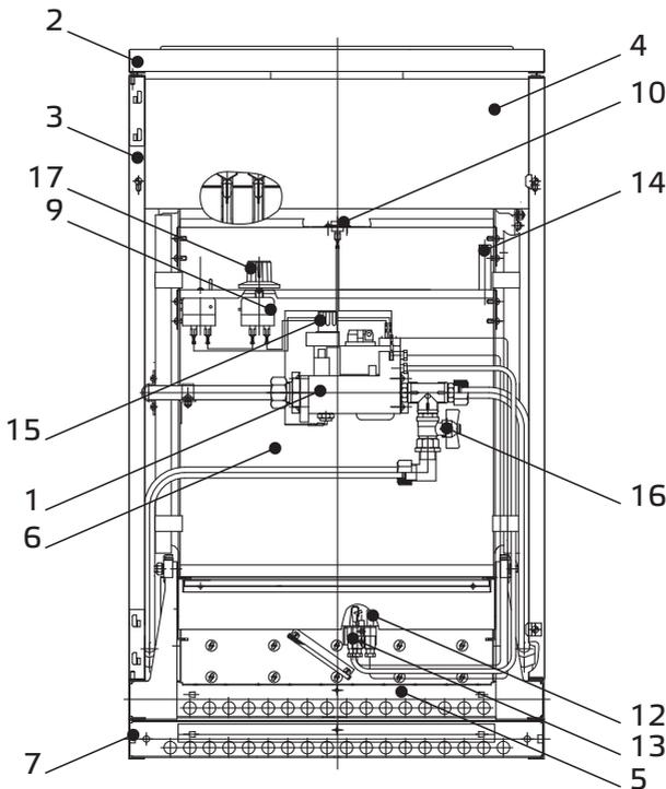
1 — теплообменник; 2 — крышка; 3 — стенка; 4 — устройство газоотводящее; 5 — горелка основная; 6 — горелка запальная (пилотная горелка); 7 — рама; 8 — блок газовый; 9 — терморегулятор (термостат); 10 — датчик тяги; 11 — термостат предельный; 12 — термогенератор; 13 — термопара; 14 — пьезорозжиг; 15 — кнопка магнитного клапана; 16 — змеевик; 17 — ручка-указатель
