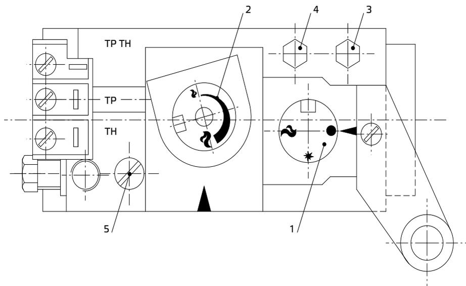
1 — кнопка магнитного клапана; 2 — ручка расхода газа; 3 — точка измерения входного давления; 4 — точка измерения выходного давления; 5 — винт настройки расхода газа на запальную (пилотную) горелку
