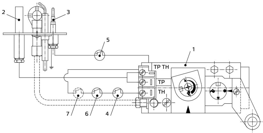
1 — блок газовый; 2 — термогенератор; 3 — термопара; 4 — регулировочный термостат TG200; 5 — датчик тяги; 6 — предельный термостат TG400; 7 — комнатный термостат (поставка под заказ)
