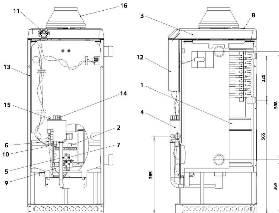
1 — теплообменник; 2 — горелка основная; 3 — крышка; 4 — газовый клапан; 5 — искровой электрод; 6 — кабель пьезо; 7 — запальная горелка (пилотная горелка); 8 — датчик тяги; 9 — термopapa; 10 — терморыватель; 11 — термометр; 12 — стенка передняя; 13 — стенка боковая левая / правая; 14 — ручка: указатель терморегулятора (кнопка клапана магнитного); 15 — крышка с пьезорозжигом; 16 — зонт.
